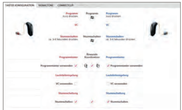
Abb. 2: In der Anpass-Software wird die Bedienung über die Tasten konfiguriert.
