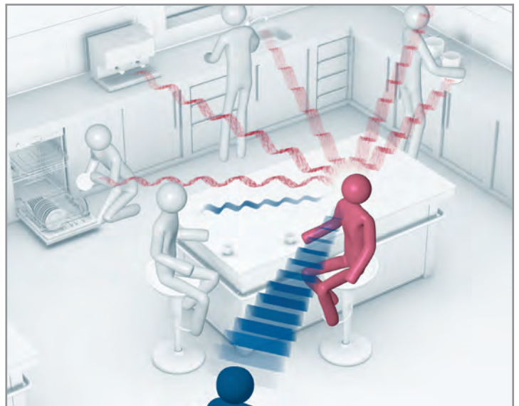
Abb. 2: Das 3D Lärm-Management erkennt durch binauralen Abgleich das Ohr mit dem besseren SNR und maximiert auf dieser Seite das Sprachverstehen.
