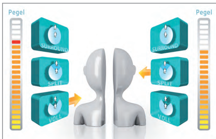
Abb. 1: Unabhängig arbeitende Hörsysteme können unterschiedliche Einstellungen der Richtmikrofone wählen.
