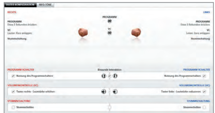
Abb. 2: Binaurale Koordination für Hörsysteme mit Taster (Ex-Hörer Mini im oberen Bild und Kanal-System im unteren Bild). In dieser Einstellung wird jeweils die Lautstärke mit einem kurzen Tastendruck am linken Gerät für beide Geräte reduziert und am rechten Gerät erhöht. Die Programme werden mit einem 2-Sek.-Druck am rechten Gerät für beide Geräte hoch geschaltet (z.B. von P1 zu P2) und am linken Gerät abwärts (z.B. von P2 zu P1).
