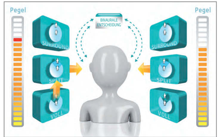
Abb. 2: Hörsysteme mit Binauraler Synchronisation wählen auf beiden Seiten die gleiche Einstellung der Richtmikrofone.
