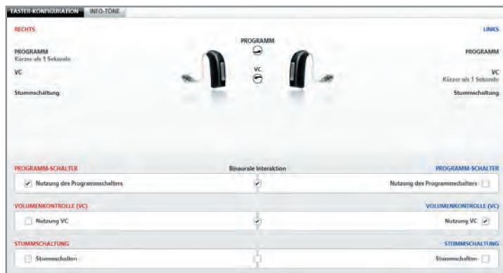
Abb. 1: Binaurale Koordination für Hörsysteme mit Wipp-Schalter. In dieser Einstellung wird die Lautstärke am linken Gerät für beide Geräte verändert. Die Programme werden am rechten Gerät für beide Geräte geschaltet. Die Änderung erfolgt jeweils mit einem kurzen Tastendruck.
