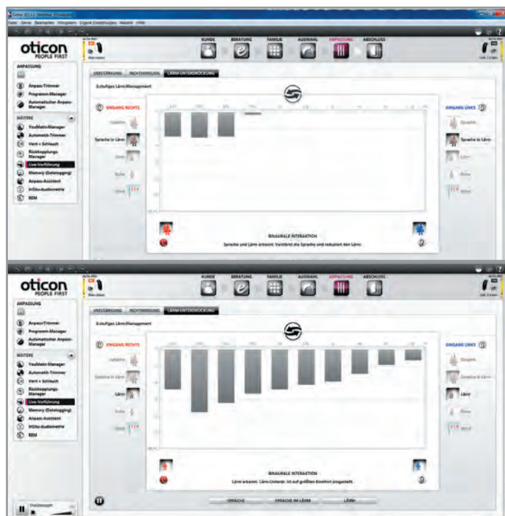
Abb. 2: Dargestellt ist die Wirkung des 3-stufigen Lärm-Managements in mehreren Kanälen für die Signale „Sprache im Lärm“ (oberes Bild) und „Lärm“ (unteres Bild).
