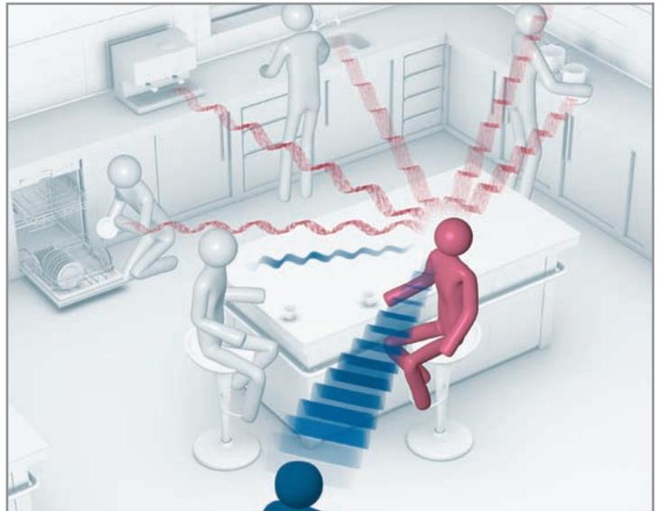
**Abb. 2:** Das 3D Lärm-Management erkennt durch binauralen Abgleich das Ohr mit dem besseren S/N und maximiert auf dieser Seite das Sprachverstehen.
