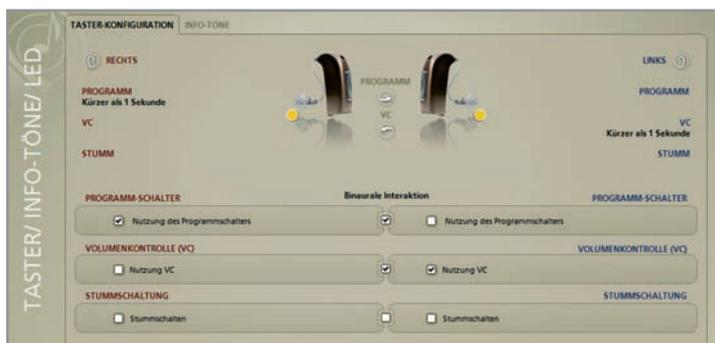
**Abb. 1:** Binaurale Koordination für Hörsysteme mit Wipp-Schalter. In dieser Einstellung wird die Lautstärke am linken Gerät für beide Geräte verändert. Die Programme werden am rechten Gerät für beide Geräte geschaltet. Die Änderung erfolgt jeweils mit einem kurzen Tastendruck.
