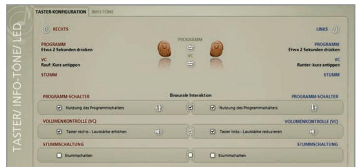
**Abb. 2:** Binaurale Koordination für Hörsysteme mit Taster (Ex-Hörer Mini im oberen Bild und Kanal-System im unteren Bild). In dieser Einstellung wird jeweils die Lautstärke mit einem kurzen Tastendruck am linken Gerät für beide Geräte reduziert und am rechten Gerät erhöht. Die Programme werden mit einem 2-Sek.-Druck am rechten Gerät für beide Geräte hoch geschaltet (z.B. von P1 zu P2) und am linken Gerät abwärts (z.B. von P2 zu P1).
