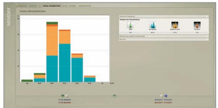
**Signal-Verarbeitung:** Diese Registerkarte zeigt in einem so genannten „Pegel Envirogramm“, unter welchen akustischen Bedingungen die Hörsysteme getragen worden sind und welche Signal-Verarbeitungen (Direktionalität, 3-stufige Lärm-Unterdrückung) aktiv waren.
