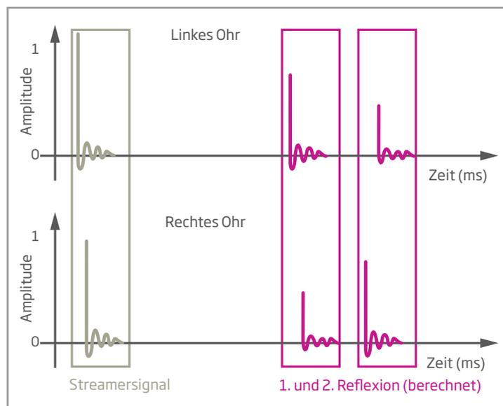
**Abb. 2:** Der Schall vom Streamer wird bei Musik-Panorama ergänzt durch rechnerisch ermittelte Reflexionssignale. Diese werden durch binaurale Signalverarbeitung links und rechts unterschiedlich berechnet. Daraus ergibt sich eine virtuelle Raumakustik - ein Musik-Panorama.
